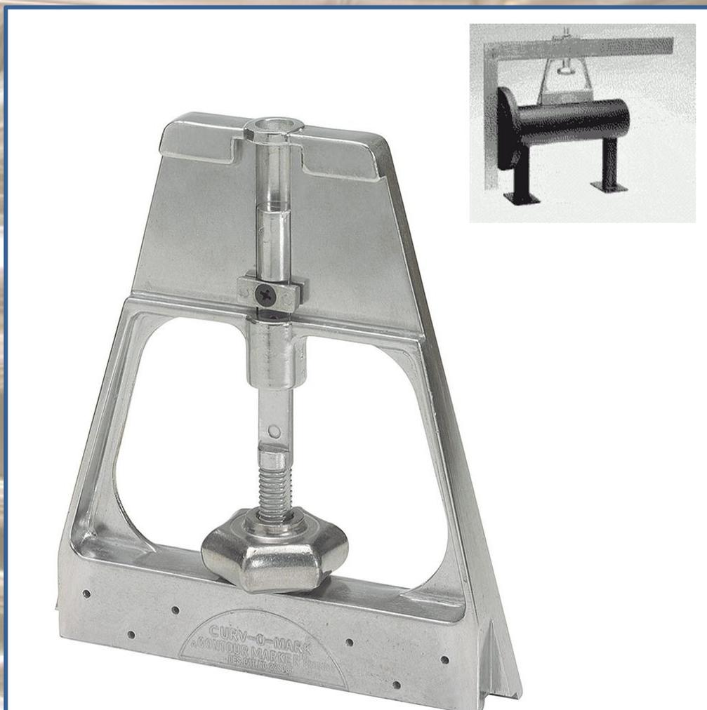
Elimina le difficoltà di allineamento e squadratura delle flange. La base, dotata di due magneti per mantenere la posizione, è intagliata su entrambe le estremità per facilitare l'allineamento sull'asse centrale del tubo. Nello scasso superiore si può inserire una normalissima squadra (non compresa) che viene fermata dalla vite centrale. Il diametro minimo del tubo consigliato è 1", quello massimo dipende dalle dimensioni della squadra.
