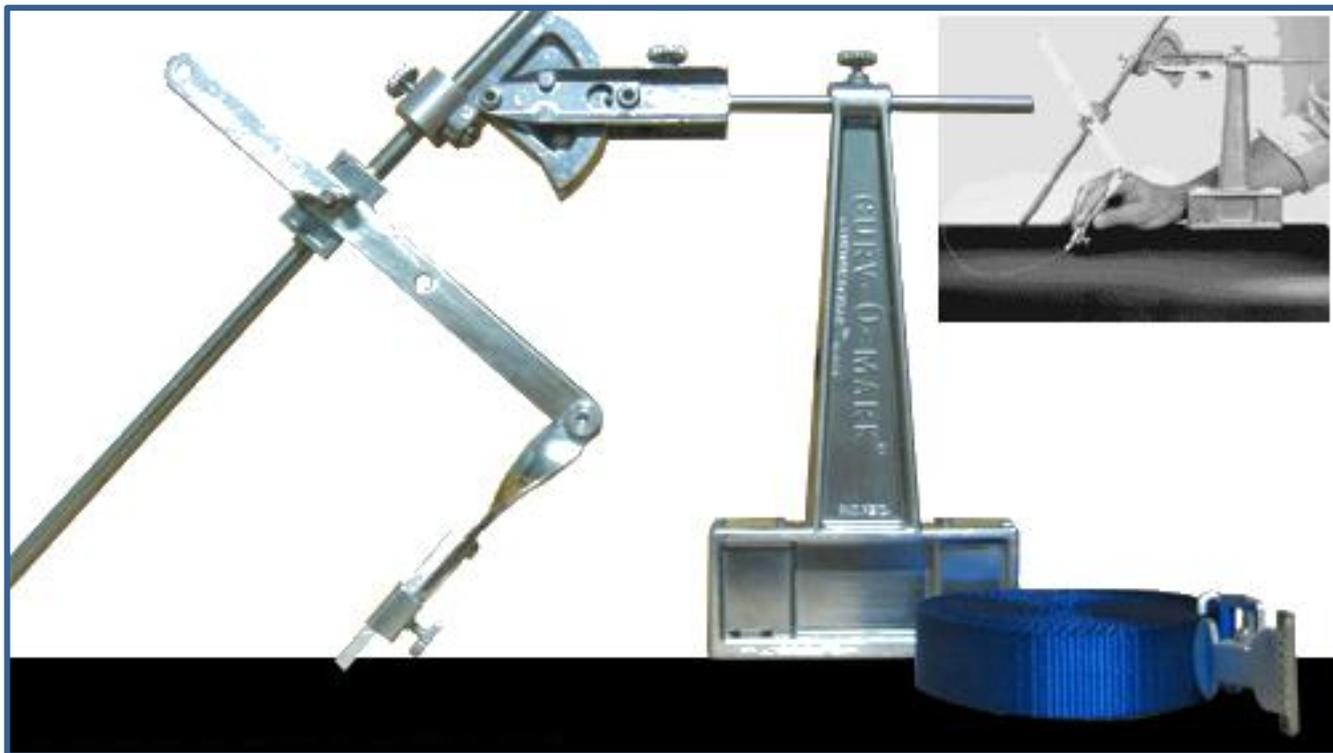
Ora è possibile realizzare facilmente cerchi ed ellissi su qualsiasi superficie piatta, tubo o irregolare che sia. Questo tracciatore circolare ellittico è composto da un goniometro con aste scorrevoli e una leva regolabile per bloccarne la posizione.
