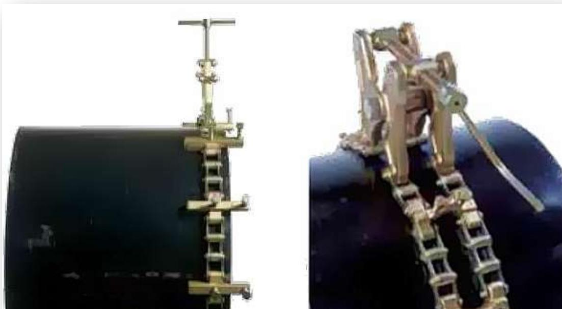
Questi robusti accoppiatori possono allineare tubi da 8" a 60" con spessore fino a 12,7 mm semplicemente posizionandosi col serraggio tra i tubi da saldare. Si adattano al diametro dei tubi intervenendo sulla lunghezza della catena e sul numero di staffe che possono essere aumentate o diminuite. Su richiesta sono disponibili accoppiatori per diametri superiori a 60".
