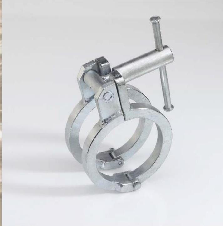
Accoppiatori a gabbia con morsetto di serraggio per saldature verticali e discendenti su tubi da DN 100 a DN 500. Questo particolare accoppiatore permette di saldare senza puntatura preventiva. È spesso utilizzato per la costruzione di tubazioni al posto degli accoppiatori interni per i quali è richiesta un'unica passata prima della loro rimozione.
