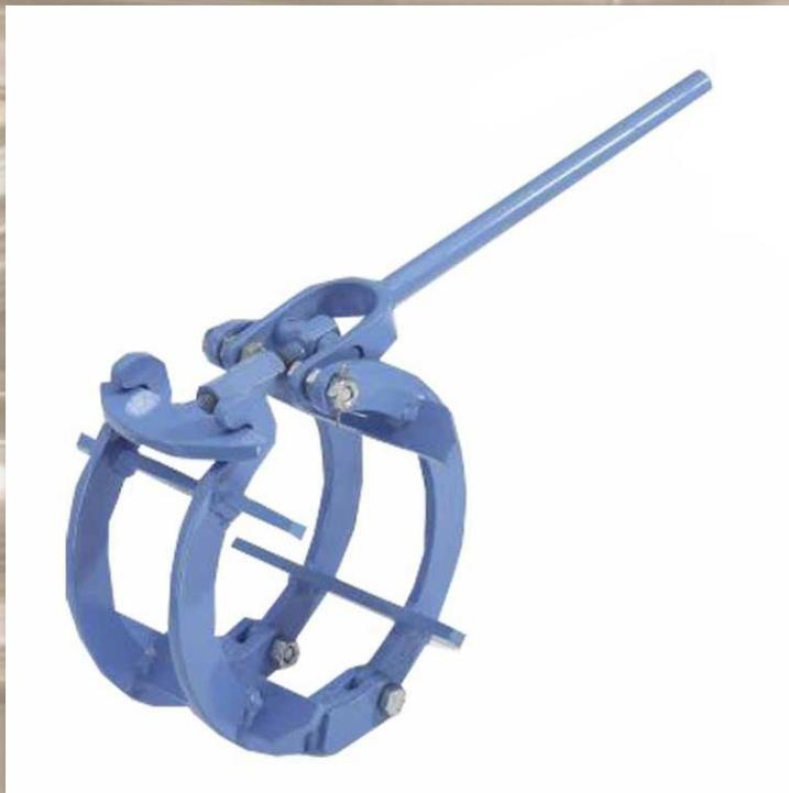
Accoppiatore per tubi DN 80 - DN 400 tipo leggero. È particolarmente adatto per la puntatura verticale sia MIG che autogena. Tramite il centratore, le estremità dei tubi potranno essere allineate tramite le staffe a ponte senza possibilità di sfasamento dei tubi.
