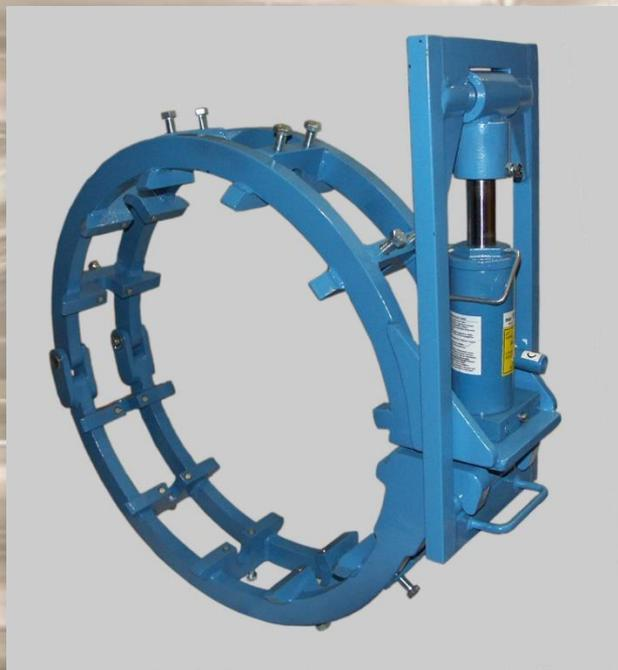
Accoppiatore a gabbia versione "super heavy duty" per impieghi gravosi dotato di cilindro idraulico da 20 ton. di forza premente. Esso lavora in posizione verticale e se necessario può essere facilmente sostituito.
