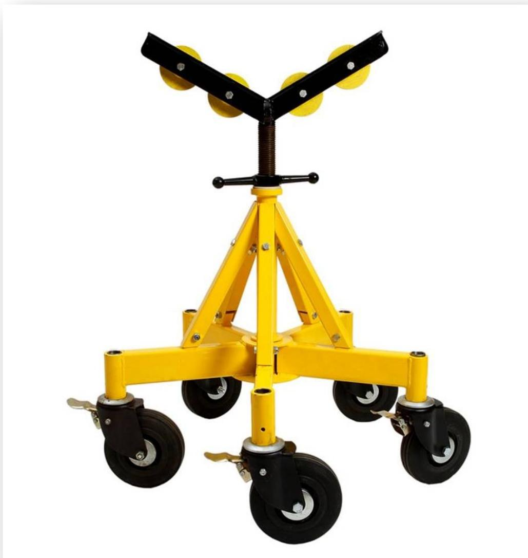
I cavalletti Flexi sono stati studiati per carichi pesanti. Sono dotati di 5 gambe con ruote da 20 cm di diametro tutte piroettanti e frenabili per una più facile movimentazione in ogni direzione e per un sicuro stazionamento in opera. La testa a "V" è dotata di 4 ruote e misura circa 90 cm.
