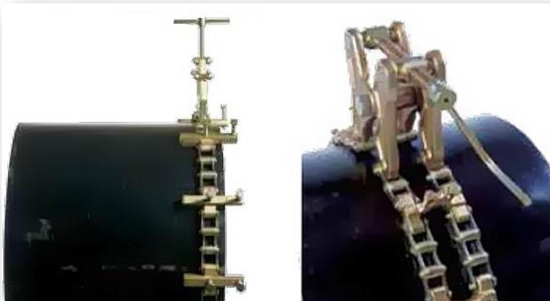
Possono allineare tubi con spessore fino a 127 mm semplicemente posizionando il serraggio sul tubo. Per ottenere il diametro desiderato si interviene sulla catena allungandola o accorciandola. Range di lavoro: 8" a 60".
