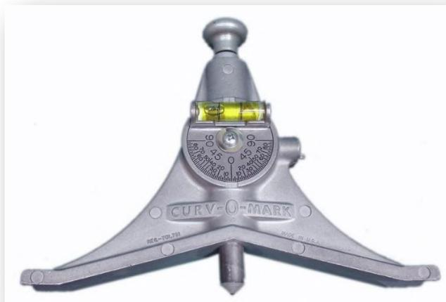
Questi strumenti permettono di tracciare longitudinalmente il centro di un tubo che sia la parte superiore (0°) o una parte laterale a destra o sinistra sino a 90° oltre il quale si deve capovolgere il tubo. Il modello STD (sopra a sinistra) è dotato di goniometro e di un grano di fermo della punta tracciante.
