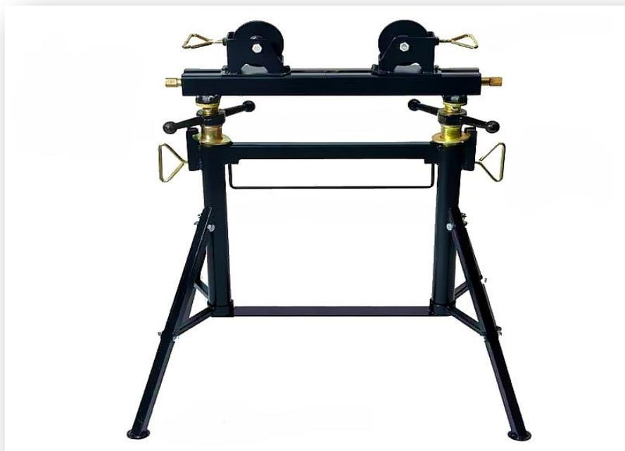
I cavalletti multi sono composti da una testa con ruote bloccabili che supportano tubi con diametri da 4" a 36". Tale testa, regolabile in altezza è bloccabile da maniglie laterali di sicurezza e da anelli di blocco corsa. Una apposita barra permette lo sblocco rapido della testa, che è montata su un telaio con gambe richiudibili.
