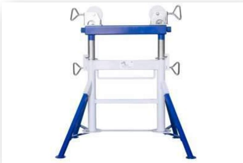
I cavalletti Twin sono caratterizzati da una testata su cui vanno montate le ruote bloccabili (non comprese nel cavalletto – vedere sotto) che supportano tubi con diametri OD da 108 mm a 900 mm. Tale testata, regolabile in altezza, è bloccabile da maniglie laterali di sicurezza e da anelli di blocco corsa. Una apposita barra permette lo sblocco rapido della testa montata sul telaio.
