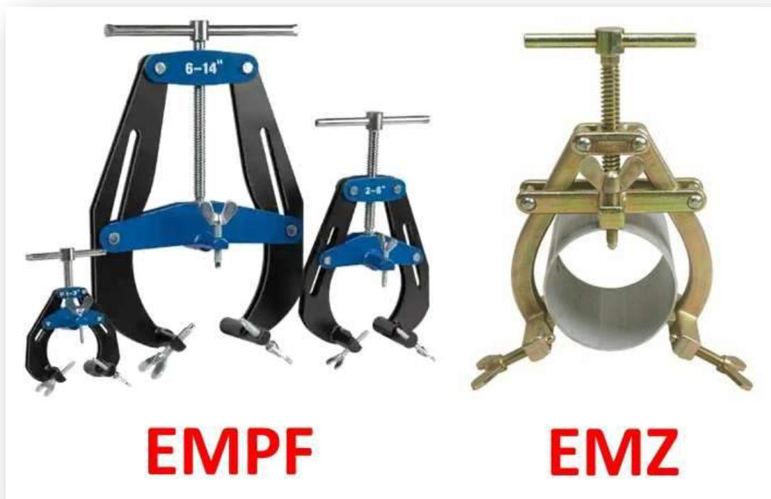
Facili e rapidi da posizionare, possono essere usati per configurazioni tubo-tubo, tubo-curva e tubo-T. Il modello EMPF può essere usato direttamente su tubi in inox in quanto i punti di contatto in acciaio inossidabile. L'EMZ è in acciaio galvanizzato.
