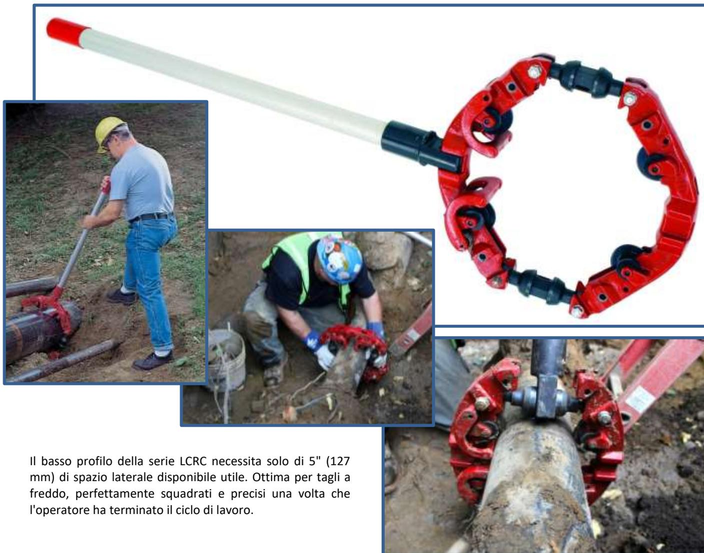
Il basso profilo della serie LCRC necessita solo di 5" (127 mm) di spazio laterale disponibile utile. Ottima per tagli a freddo, perfettamente squadrati e precisi una volta che l'operatore ha terminato il ciclo di lavoro.
