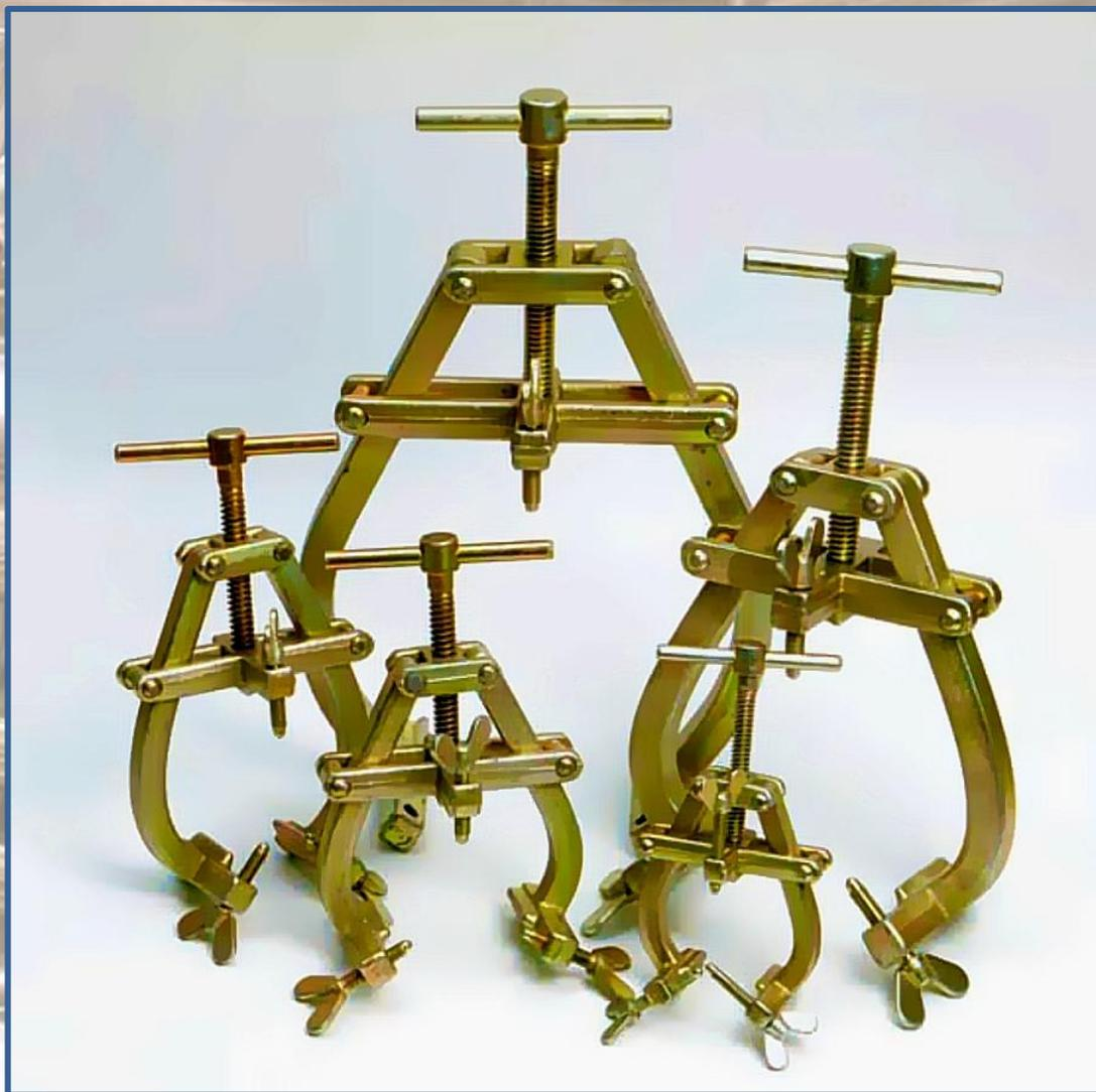
Il robusto accoppiatore a morsetto EMZ è progettato per l'unione tra tubo-tubo, tubo-curva e tubo-flangia. Ha una struttura robusta ed affidabile in acciaio galvanizzato che tramite un posizionamento rapido e sicuro permette di lavorare con facilità ed agilità su tubi con diametri compresi tra 1 e 14". Le viti di regolazione assicurano un serraggio stabile e che non danneggia il tubo.
