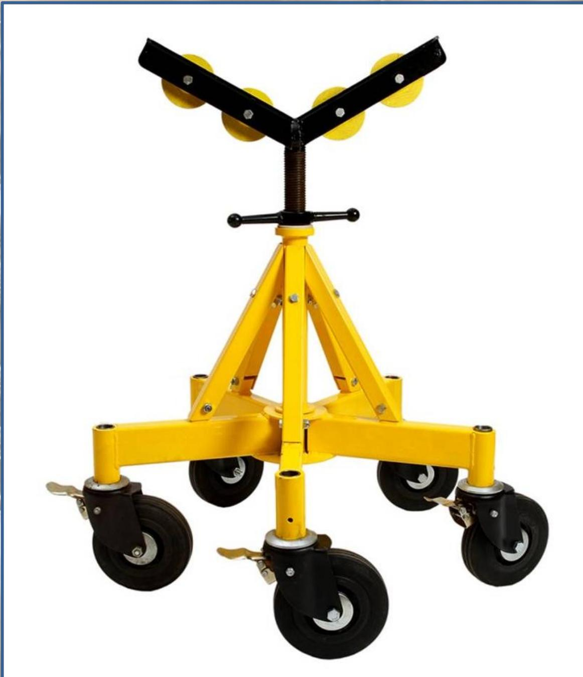
I cavalletti Flexi sono stati studiati per carichi pesanti. Sono dotati di 5 gambe con ruote da 20 cm di diametro tutte piroettanti e frenabili per una più facile movimentazione in ogni direzione e per un sicuro stazionamento in opera. La testa a "V" è dotata di 4 ruote e misura circa 90 cm.
