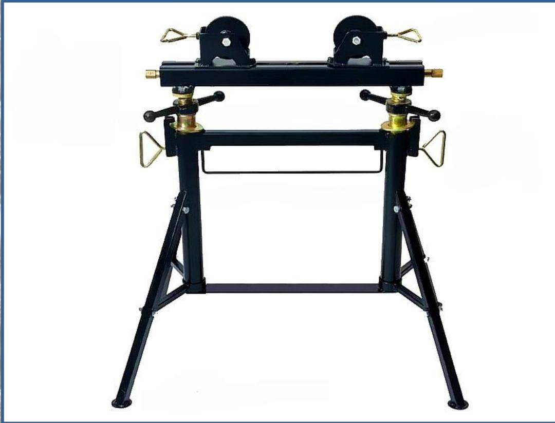
I cavalletti multi sono composti da una testa con ruote bloccabili che supportano tubi con diametri da 4" a 36". Tale testa, regolabile in altezza è bloccabile da maniglie laterali di sicurezza e da anelli di blocco corsa. Una apposita barra permette lo sblocco rapido della testa, che è montata su un telaio con gambe richiudibili.
